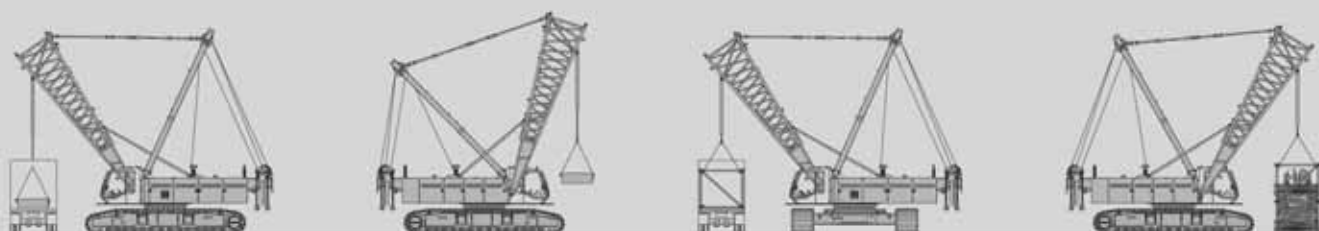
Déchargement et montage du contre poids central
