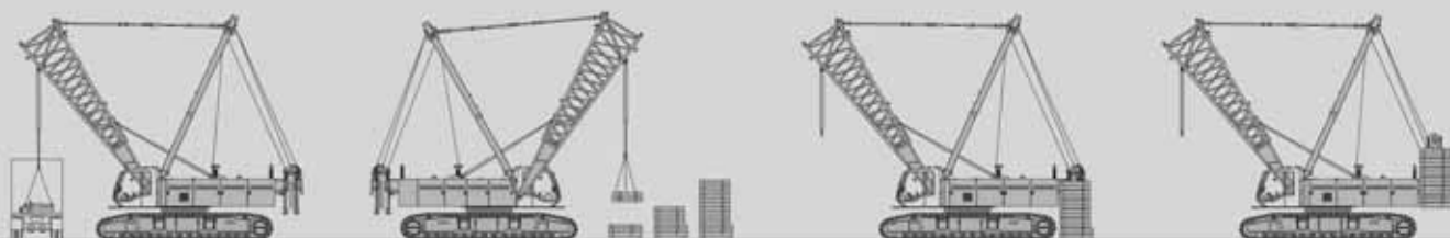
Déchargement, assemblage et montage du contre poids
